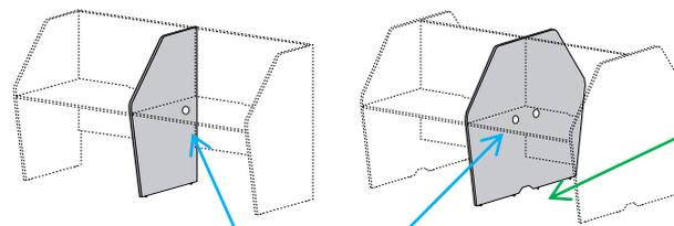
Круглые отверстия для пропуска проводов в промежуточных стенках
